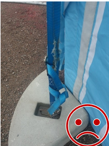
Kuormaliina on kulunut.
