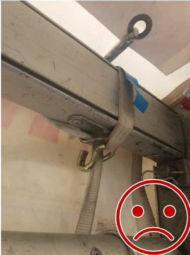
Kuormaliina leikkaantuu kiristyessään.
